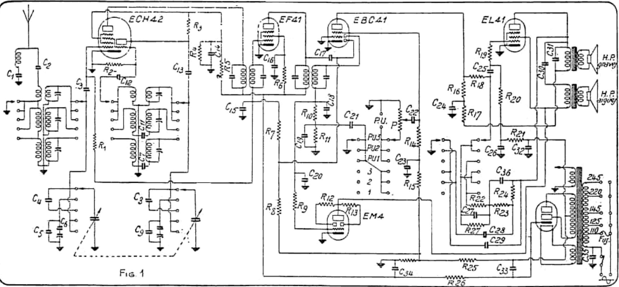
3°) 5 gammes : PO\_GO OC1 (13 à 60 m.) - OC2 bande étalée 25 m., OC3 bande étalée 50 m.
